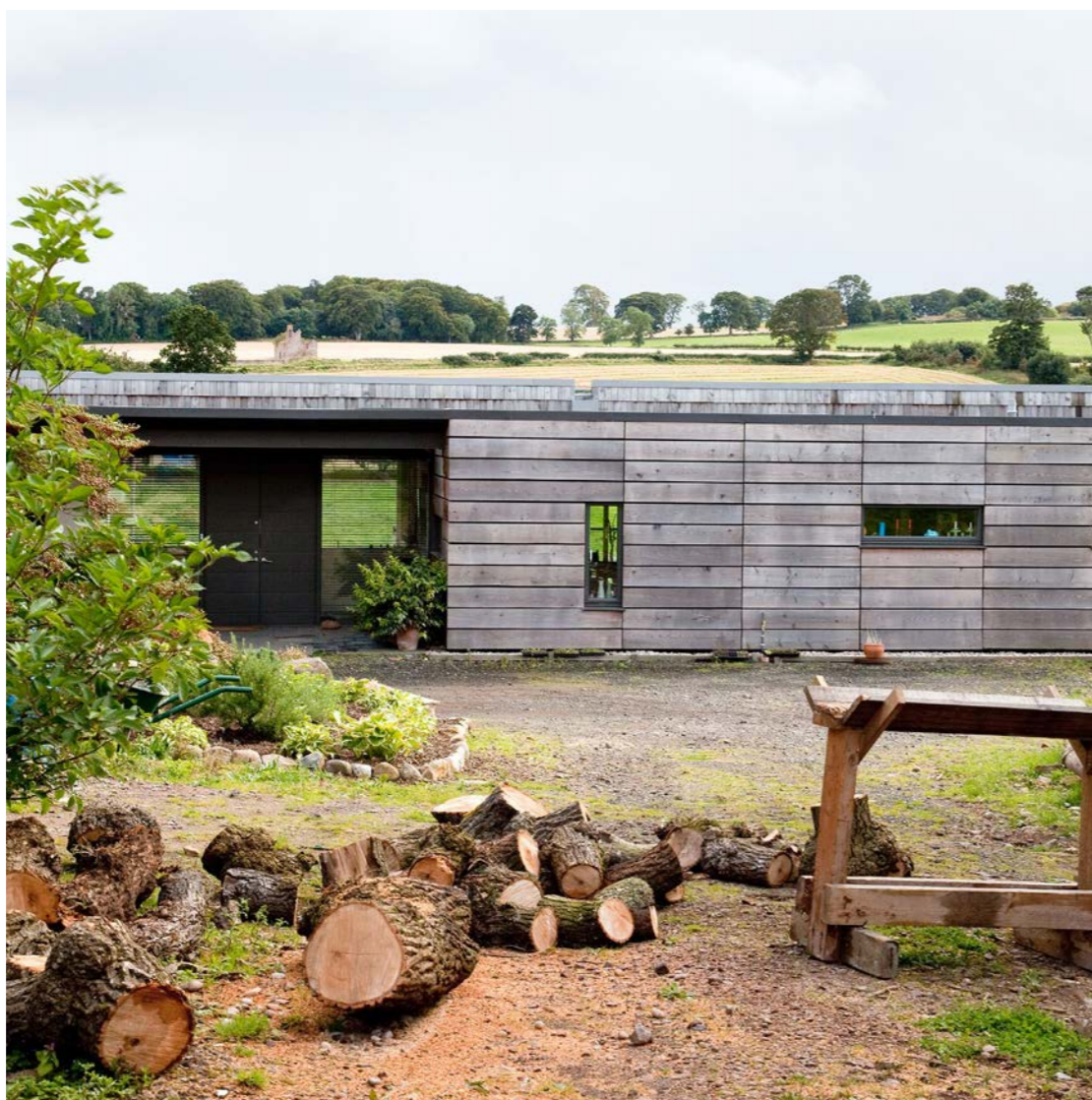
2 referencer på lærke-træs-facader, som har fået lov til at stå i 8-9 år uden behandling.
